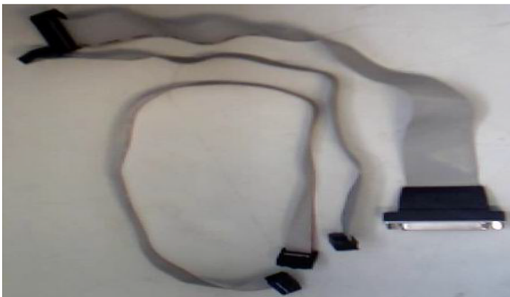
تصویر کابل‌های داده ارتباطی بین بردها
