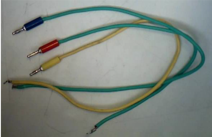
تصویر کابل‌های ارتباطی بین ترمینال ورودی و بردها
